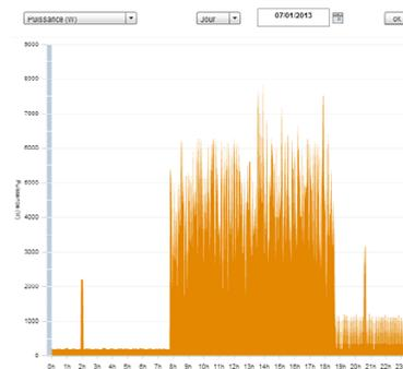
Exemple de courbe de charges avec points 10 minutes. Il correspond au suivi des consommations des bureaux parisiens d'EcoCO2, le lundi 7 janvier 2013. On voit nettement que le chauffage a été mis en marche à l'arrivée des occupants un peu avant 8h puis mis en position réduite sans être arrêté le soir en partant vers 18h40.
