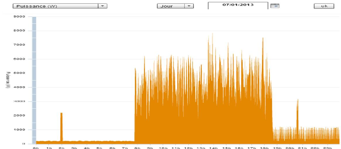
Exemple de courbe de charges avec points 10 minutes. Il correspond au suivi des consommations des bureaux parisiens d'EcoCO2, le lundi 7 janvier 2013. On voit nettement que le chauffage a été mis en marche à l'arrivée des occupants un peu avant 8h puis mis en position réduite sans être arrêté le soir en partant vers 18h40.
