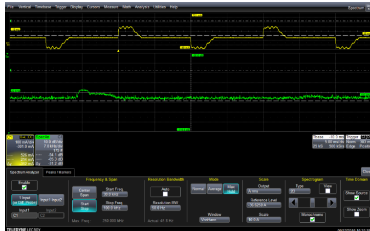
Figure 5-8: courant électrique (en haut) et spectre dans la bande 30 kHz – 95 kHz (en bas) Câble branché sur une lampe fluo compacte
