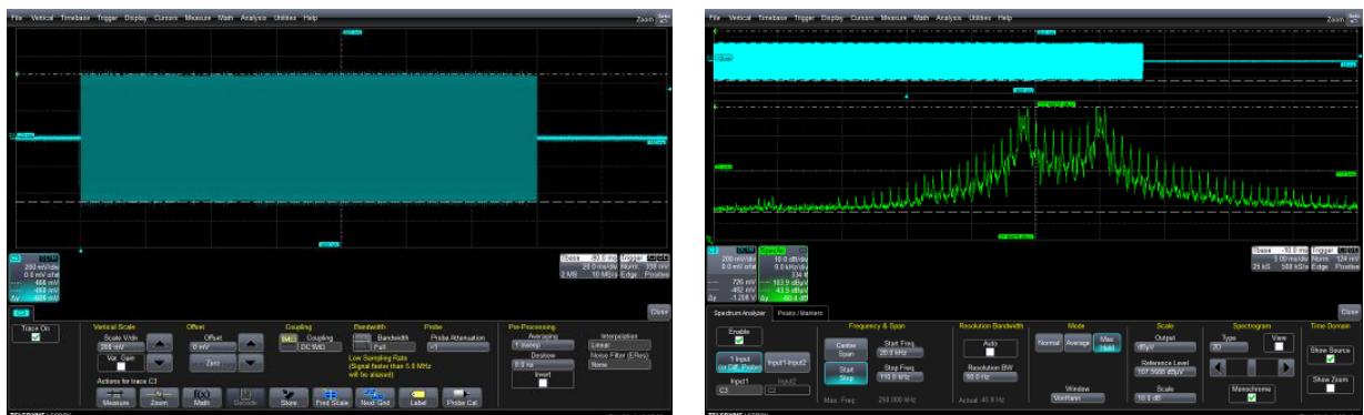
Figure 3-7: mesure de tension en sortie du compteur G1 : visualisation d'une trame (à gauche) et du spectre dans la bande de fréquences CPL Linky (à droite)
