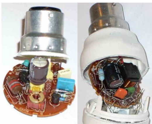
Figure N°3 : ballasts électroniques de lampes fluo-compactes
