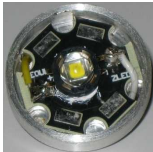
Figure 107 : Le composant à LED. Diamètre support 24 mm
